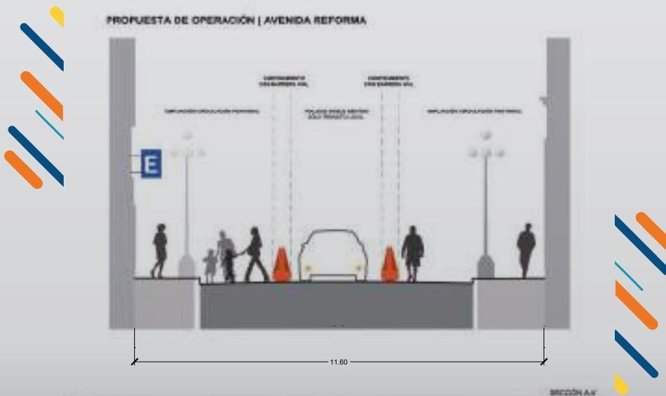
Sección tipo para colocación de elementos de confinamiento en Avenida Reforma
