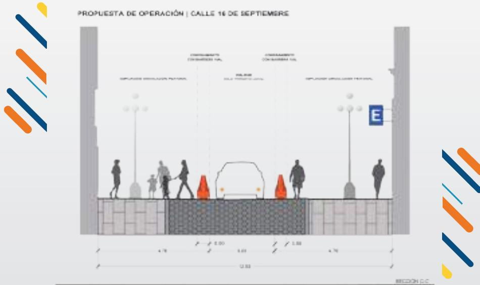
Sección tipo para colocación de elementos de confinamiento en Calle 16 de Septiembre
