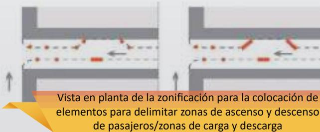
Vista en planta de la zonificación para la colocación de elementos para delimitar zonas de ascenso y descenso de pasajeros/zonas de carga y descarga
