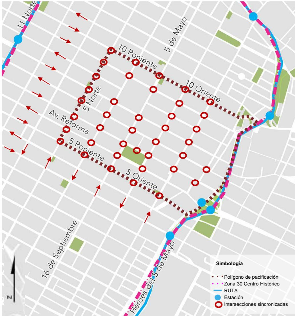
**40 Intersecciones sincronizadas para una velocidad de 30 km/h**
